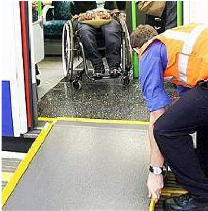
Входные двери (предназначенные для посадки/ высадки инвалидов) оборудованы выдвижными (откидными) трапами или подъемниками.
