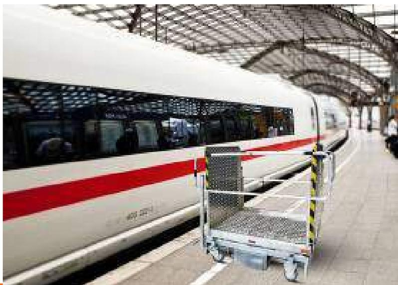
б) Использование лифта для кресел-колясок, устанавливаемого на платформе; постоянный или временный пандус, прилегающий вплотную к уровню пола в вагоне поезде.
