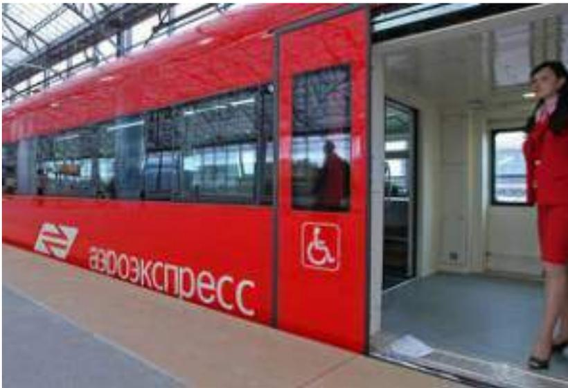
2. Каждая дверь транспортного средства, предназначенная для доступа пассажиров с инвалидностью, должна иметь снаружи и внутри ТС соответствующие обозначения (надписи и пиктограммы) и специальную световую и звуковую сигнализацию.
