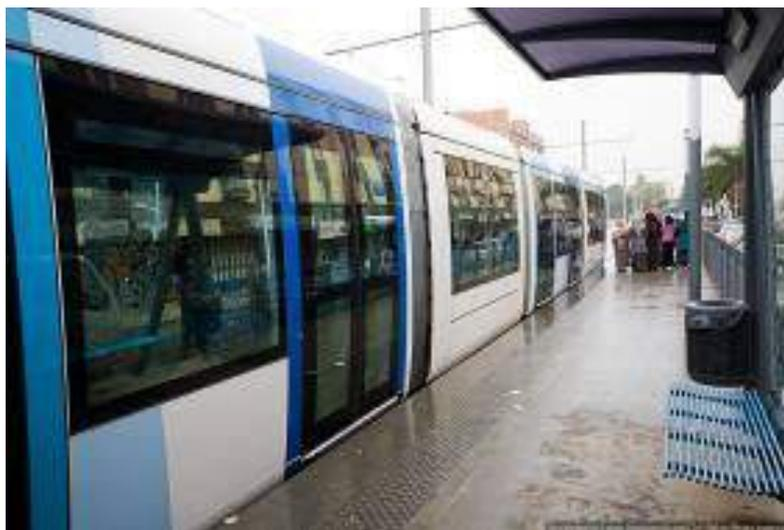
а) Высота станционной платформы обеспечивает поезду возможность вплотную подойти к ее краю, для исключения необходимости использования ступеней/рампы для перекрытия расстояния между полом вагона и станционной платформой;
