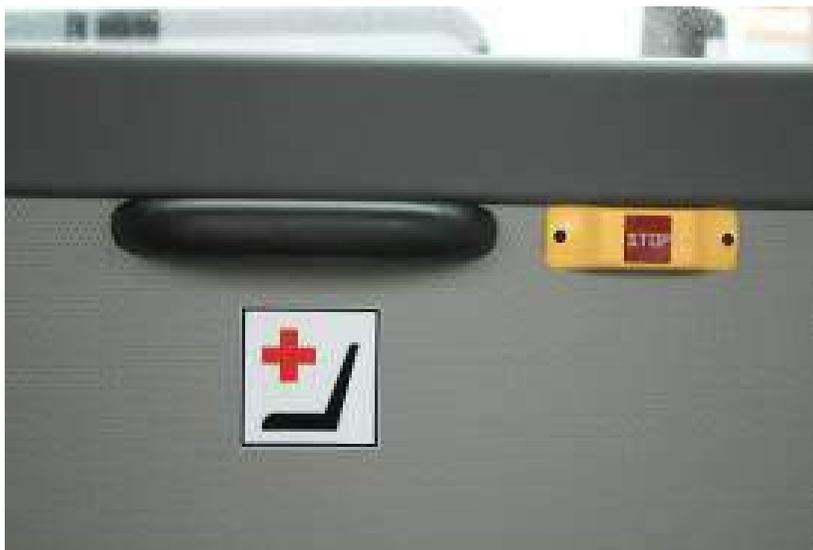
8. В зоне размещения инвалида в кресле-коляске в транспортном средстве должно быть предусмотрено сигнальное устройство «Выхожу на следующей остановке».
